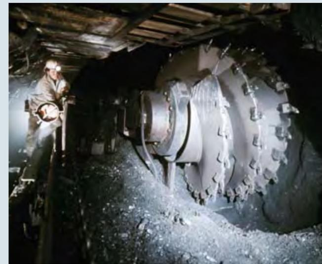
Ein Kumpel bedient eine sogenannte Schrämwälze, die die Kohle aus dem Flöz löst (undatierte Aufnahme der RuhrkohleAG).
